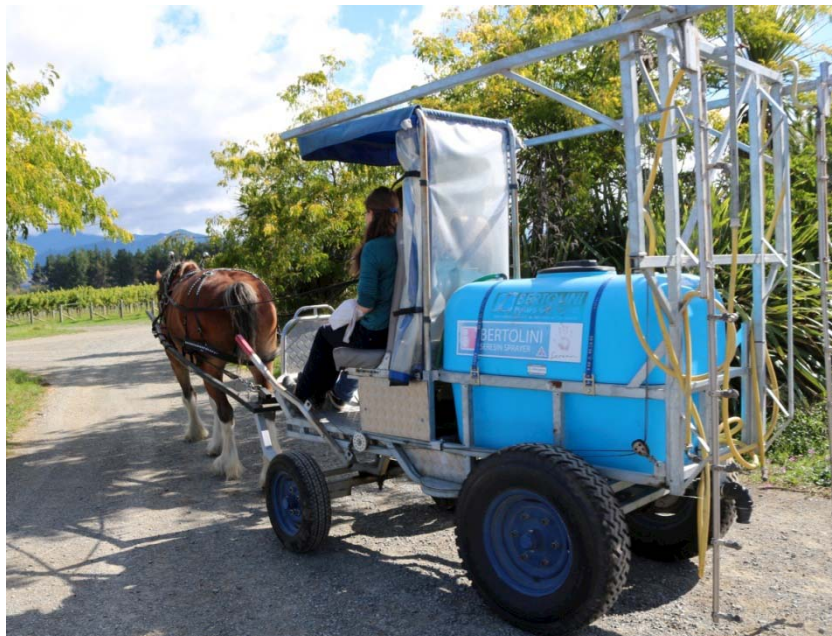
Bild 15-4: Die pferdegezogene Maschinenspritze
