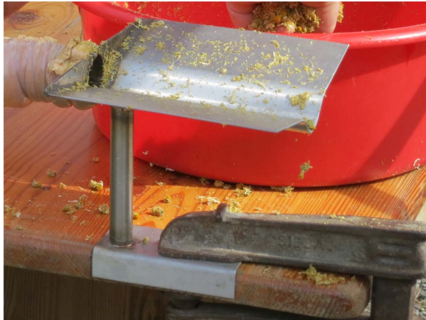
Bild 3-6 Der Trichter zum Einfüllen der Kamille, mit einer Schraubzwinge am Tisch befestigt
